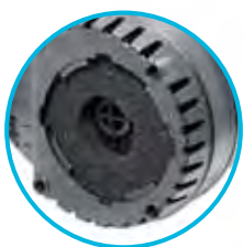
Фильтр в зоне всасывания
