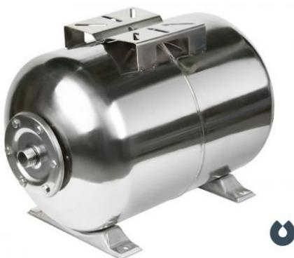
Гидроаккумуляторы UNIPUMP из нержавеющей стали — предназначены для поддержания постоянного давления в системе водоснабжения, предотвращения гидравлических ударов, а также для хранения определенного запаса воды. Наличие гидроаккумулятора в системе автономного водоснабжения позволяет снизить количество включений и выключений насоса, что увеличивает срок его службы.
