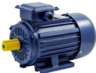
**Электродвигатель** ТМ БЭЗ АИР 132М8 IM1081 380/660 37790 широко применяется в промышленности для привода различных механизмов. Мощный асинхронный трехфазный агрегат обладает высокой надежностью и не требует специального обслуживания. Корпус имеет защиту IP 55, что обеспечивает минимальное попадание пыли и влаги внутрь прибора, возможна работа вне помещения.
